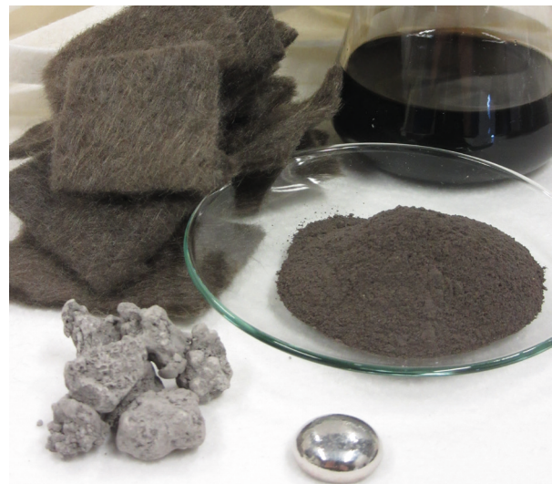
Filter-Fasern für wertvolle Metalle: Das Adsorbentextil nimmt Palladium auf, das anschließend wiederverwertet werden kann.
