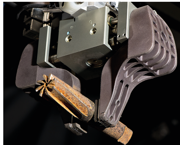
Automatischer Greifer mit aufgenommenem Schrottteil.
