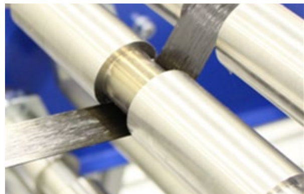
„MAREMO“-Towpreg für die materialeffiziente Endlosfaserverstärkung von Recyclingfaser-Basismaterialien.
