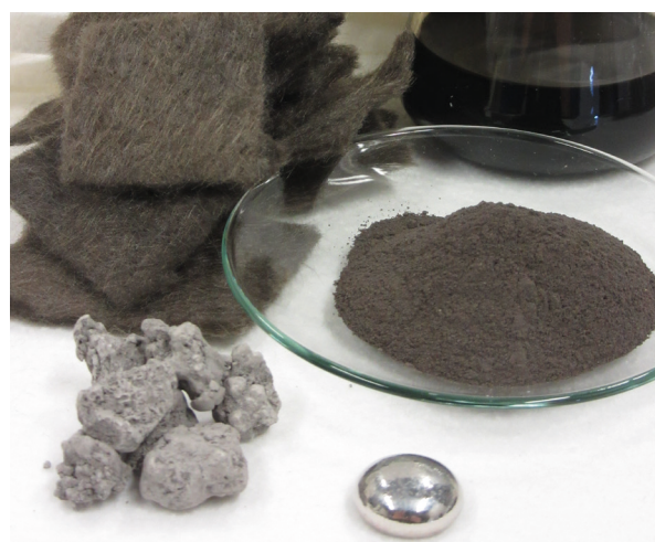
Filter-Fasern für wertvolle Metalle: Das Adsorbentextil nimmt Palladium auf, das anschließend wiederverwertet werden kann.
