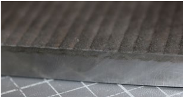
Keramik statt Wolfram: Auftragschweißen mit kostengünstigen alternativen Werkstoffen.
