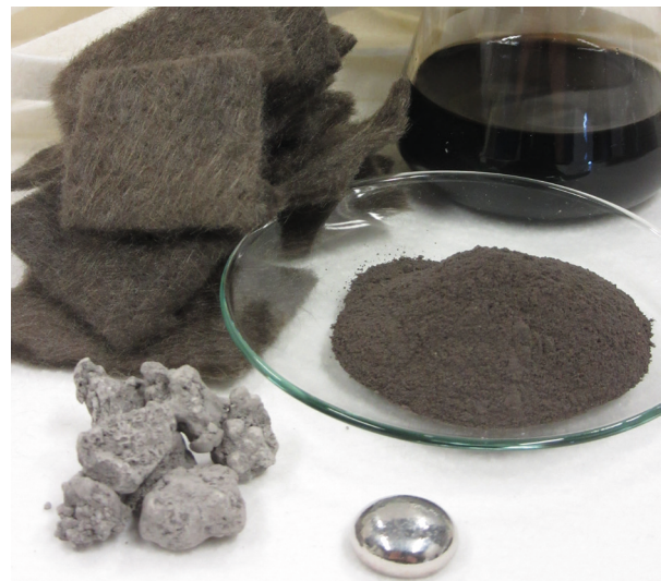
Filter-Fasern für wertvolle Metalle: Das Adsorbertextil nimmt Palladium auf, das anschließend wiederverwertet werden kann.
